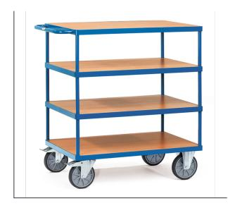
Stahlrohr und Profilstahl geschweißt, pulverbeschichtet RAL 5007. 4 Plattformen aus Holzwerkstoffplatte, Oberfläche Buchendekor. 2 Lenk- und 2 Bockrollen, TPE-Bereifung, Naben mit Rillenkugellager. Feststeller an den Lenkrollen, gemäß der Europäischen Norm EN 1757-3 (Sicherheit von Plattformwagen).
