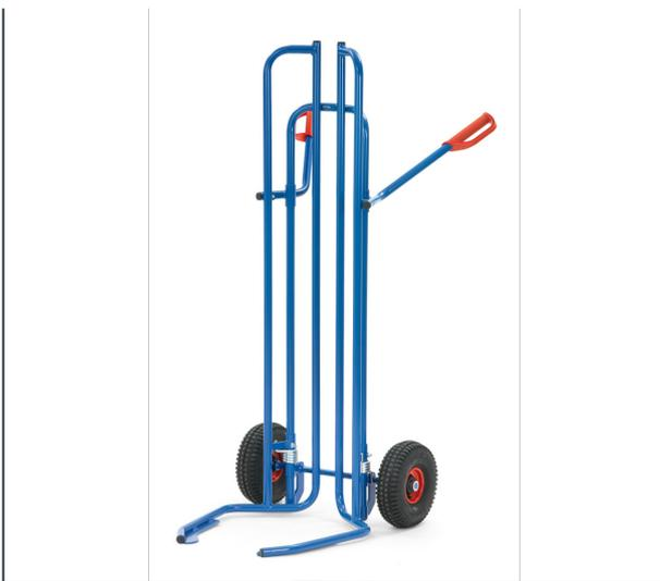
Stahlrohr geschweißt, pulverbeschichtet blau RAL 5007, dauerhaft oberflächengeschützt. Räder mit Luftbereifung. Naben mit Rollenlager. Mittels durch die Griffholme zu bedienende Spreiz-Aufnahmen können Reifenstapel direkt aufgenommen oder abgesetzt werden. Geeignet für Reifen von 450 bis 750 mm Ø. Bis zu 8 Reifen oder Räder möglich.
