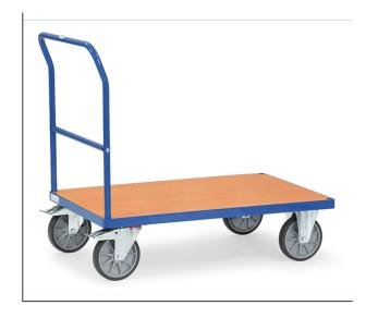
Schiebebügelwagen aus Stahlrohr und Profilstahl geschweißt, pulverbeschichtet brillantblau RAL 5007. Plattform mit Holzwerkstoffplatte, Oberfläche Buchendekor. 2 Lenk- und 2 Bockrollen, TPE-Bereifung, Naben mit Rillenkugellager. Feststeller an den Lenkrollen, gemäß der Europäischen Norm EN 1757-3 (Sicherheit von Plattformwagen).
