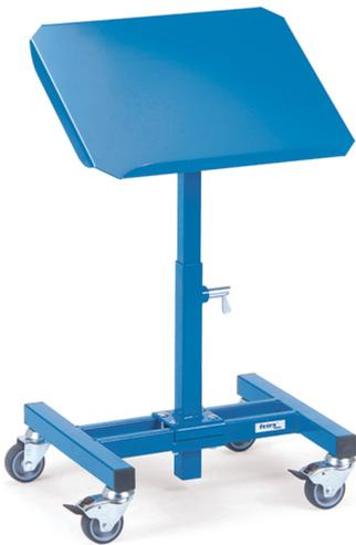
Für Kunststoffkästen, Stahlblechkästen, Drahtkörbe usw., höhenverstellbar und fahrbar. Profilstahl-/Rohrkonstruktion mit Stahlblechplattform. Stahlblechplattform mit einseitiger Anlegekante, neigbar um 15° und 30°, höhenverstellbar im Raster von 25 mm. Pulverbeschichtet blau RAL 5007. 4 Lenkrollen, Naben mit Gleitlagerung, 2 davon mit Feststeller gemäß der Europäischen Norm EN 1757-3 (Sicherheit von Plattformwagen). 3280: 500 - 775 mm höhenverstellbar
