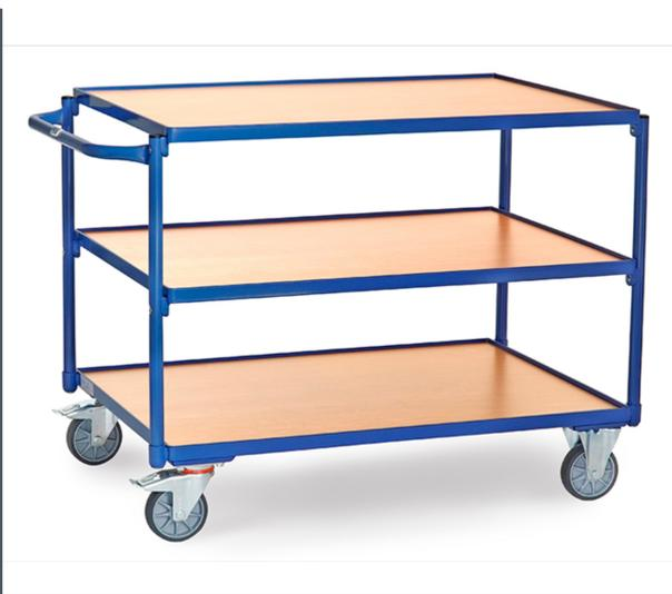
Leichter Tischwagen aus Stahlrohr und Profilstahl geschweißt, pulverbeschichtet brillantblau RAL 5007. Schraubkonstruktion. 3 Böden aus Holzwerkstoffplatte, Oberfläche Buchendekor, im Stahlrahmen liegend, Rand 12 mm hoch. Schiebegriff waagrecht. 2 Lenk- und 2 Bockrollen, TPE-Bereifung, Naben mit Rillenkugellager. Feststeller an den Lenkrollen, gemäß der Europäischen Norm EN 1757-3 (Sicherheit von Plattformwagen). Tragkraft obere und mittlere Ladefläche 80 kg.
