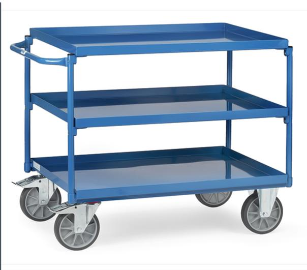
Tischwagen Stahlkonstruktion geschweißt. Mit 3 öldichten Stahlblechwannen mit 40 mm hohen Rand. Stahlrohrbügel und Stahlblechwannen verschraubt. Pulverbeschichtet brillantblau RAL 5007. Schiebegriff waagrecht. 2 Lenk- und 2 Bockrollen, TPE-Bereifung, Naben mit Rillenkugellager. Feststeller an den Lenkrollen, gemäß EN 1757-3 (Sicherheit von Plattformwagen). Tragkraft obere und mittlere Ladefläche 200 kg.
