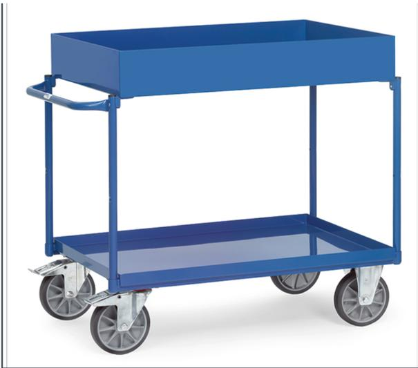
Tischwagen Stahlkonstruktion geschweißt. Mit 3 Stahlblechwannen öldicht verschweißt. Rand obere Ladefläche 150 mm hoch, Rand untere Ladefläche 40 mm hoch. Stahlrohrbügel und Stahlblechwannen werden miteinander verschraubt. Pulverbeschichtet brillantblau RAL 5007. Schiebegriff waagrecht. 2 Lenk- und 2 Bockrollen, TPE-Bereifung, Naben mit Rillenkugellager. Feststeller an den Lenkrollen, gemäß EN 1757-3 (Sicherheit von Plattformwagen). Tragkraft obere und mittlere Ladefläche 200 kg.
